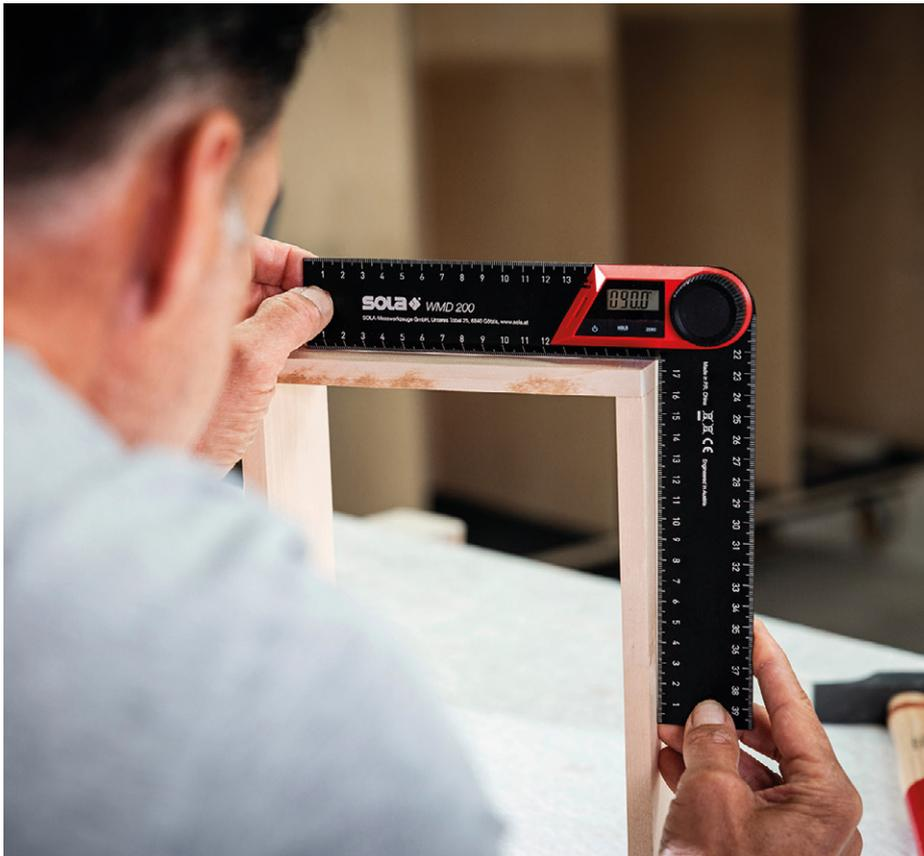
Mit dem digitalen Winkelmesser WMD lassen sich Innen- sowie Außenwinkel messen, übertragen und zeichnen.
